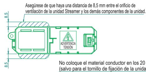
No coloque el material conductor en los 20 mm de la cinta de aluminio (salvo para el tornillo de fijación de la unidad).
