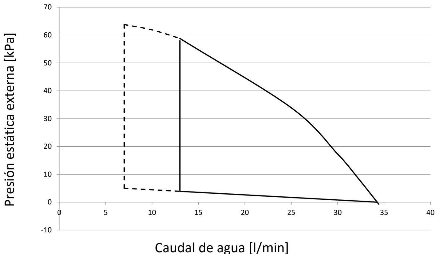
El área de funcionamiento se amplía a caudales más bajos solo si la unidad funciona únicamente con la bomba de calor.
