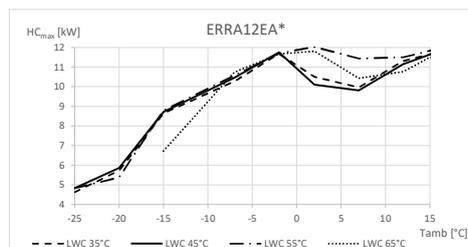
**Condiciones**Capacidad de calefacciónCapacidad de acuerdo con la norma EN 14511 y válida para el rango de agua caliente  $\Delta T = 3^{\circ}\text{--}8^{\circ}\text{C}$ .**Notas**
