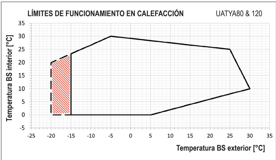
**Temperatura BS exterior [°C]:** Temperatura del aire exterior que entra en contacto con la batería de evaporación (bulbo seco).
