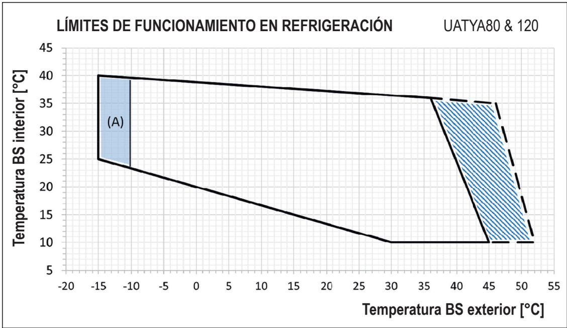
**Temperatura BS exterior [°C]:** Temperatura exterior que entra en contacto con la batería de condensación (bulbo seco).
