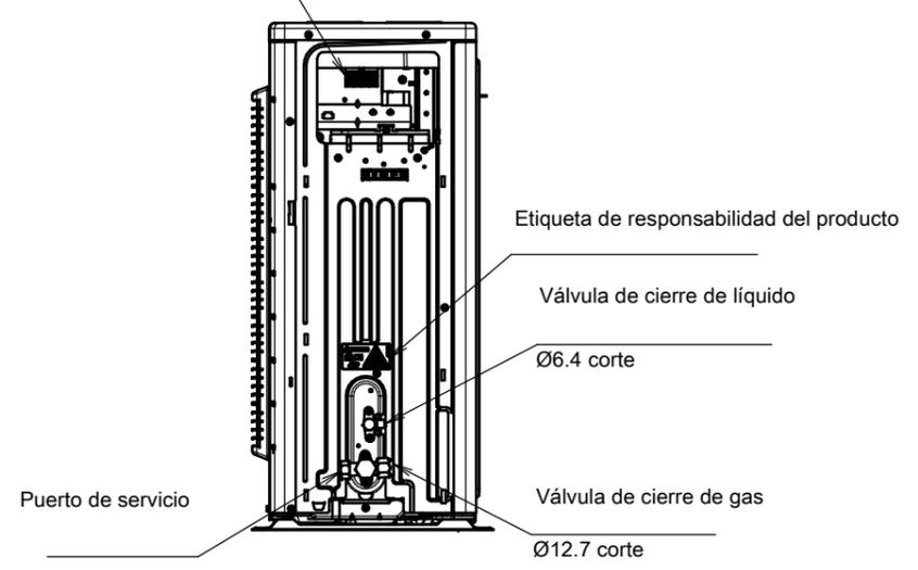
En caso de retirar la cubierta de la válvula de cierre.
