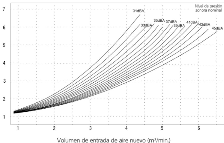
El volumen del caudal de aire de entrada máximo se indica en la siguiente tabla. Si el volumen del caudal de aire de entrada es demasiado grande, el nivel sonoro de funcionamiento del sistema puede aumentar o la detección de la temperatura de aspiración de la unidad interior puede verse afectada.
