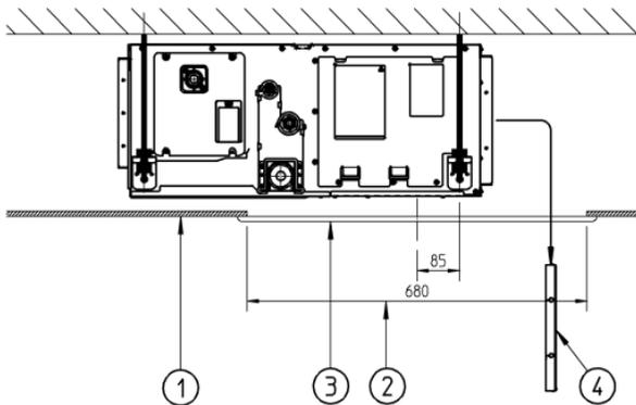
Instalación sin conducto de entrada de aire
