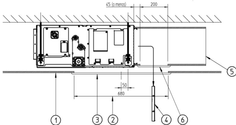
Instalación con conducto de entrada de aire
