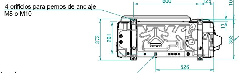
Paso de los orificios para los pernos de la base
