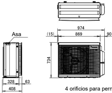
4 orificios para pernos de anclaje
