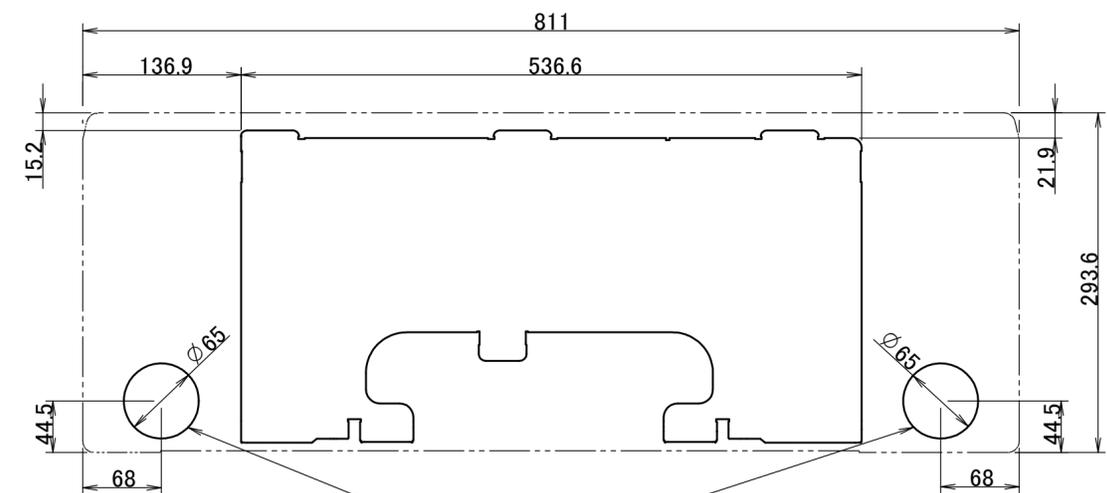
Orificio para tubería empotrada
