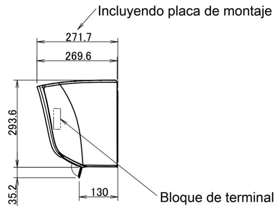
Bloque de terminales con terminal de conexión a tierra Situado en el interior de la unidad
