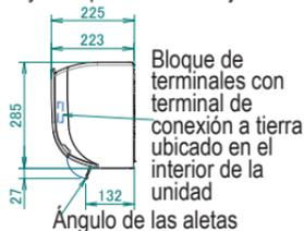
Bloque de terminales con terminal de conexión a tierra ubicado en el interior de la unidad
