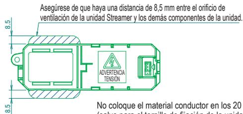
No coloque el material conductor en los 20 mm de la cinta de aluminio (salvo para el tornillo de fijación de la unidad).
