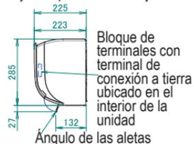
Bloque de terminales con terminal de conexión a tierra ubicado en el interior de la unidad
