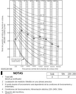
JISC9612 El método de medición del nivel sonoro de funcionamiento cumple con la norma JISC9612
