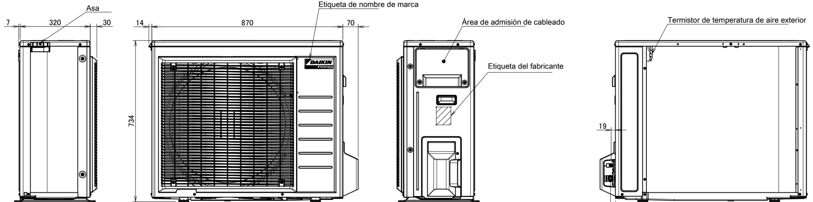
4 orificios para pernos de anclaje
