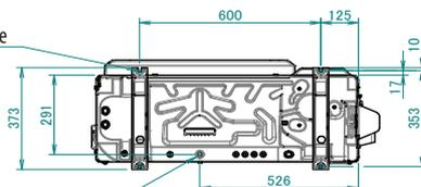
Separación de los orificios de los pernos para cimientos
