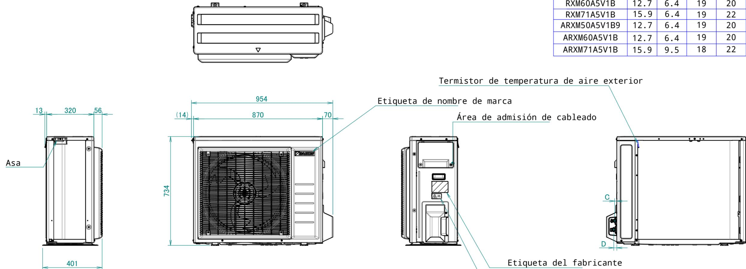
4 orificios para pernos de anclaje
