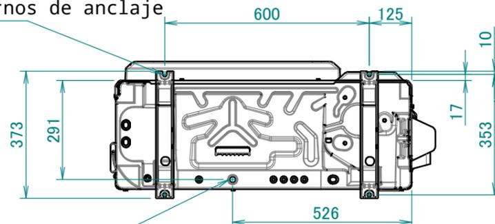
Paso de los orificios para los pernos de la base
