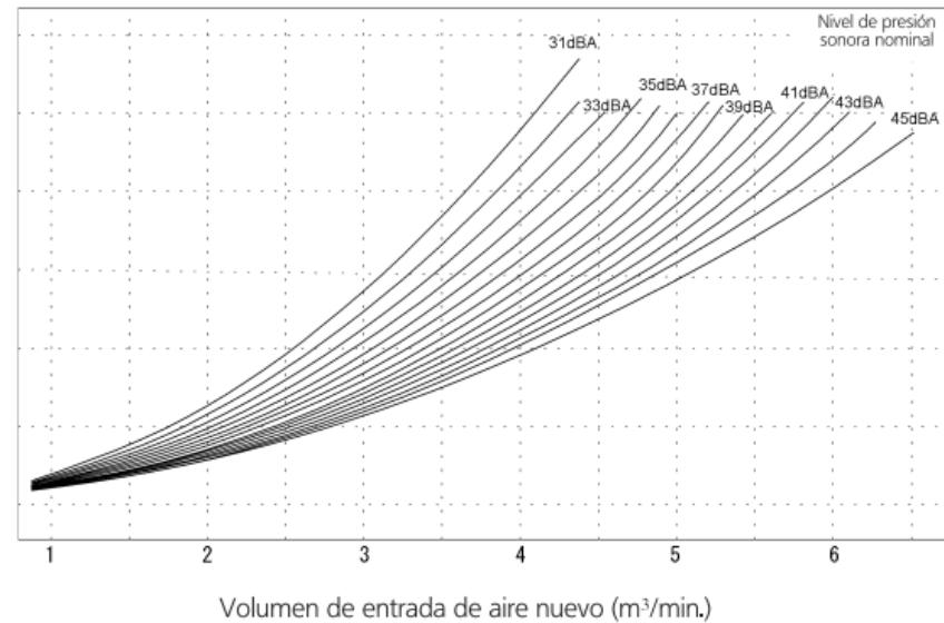
El volumen del caudal de aire de entrada máximo se indica en la siguiente tabla. Si el volumen del caudal de aire de entrada es demasiado grande, el nivel sonoro de funcionamiento del sistema puede aumentar o la detección de la temperatura de aspiración de la unidad interior puede verse afectada.
