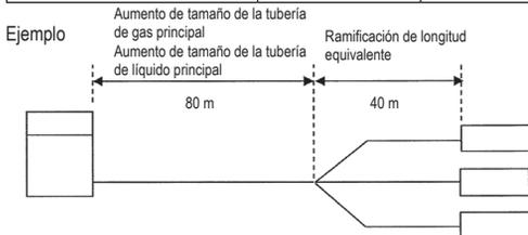
En el caso anterior (Refrigeración) Longitud de tubería total = 80 m x 0,5 + 40 m = 80 m
