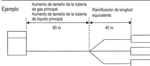
En el caso anterior (Refrigeración) Longitud de tubería total = 80 m x 1,0 + 40 m = 120 m
