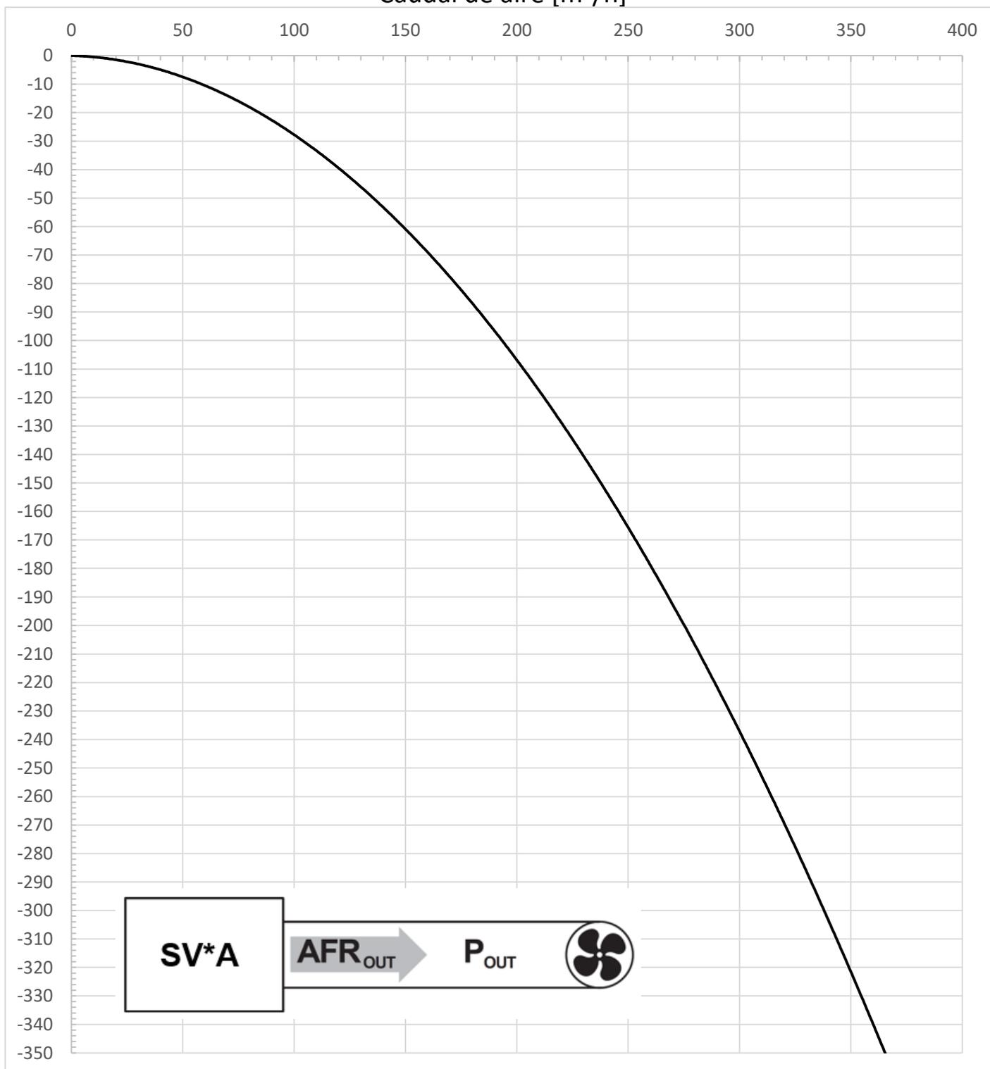
AFR<sub>OUT</sub> Caudal de aire [m<sup>3</sup>/h]P<sub>OUT</sub> Presión de salida [Pa]
