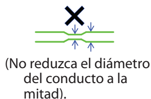
(c) Reduzca el diámetro del conducto a conectar.
