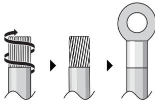
Utilice los métodos que se describen a continuación para instalar los cables:
