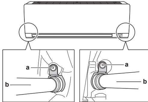
a Tornillo de fijación del aislamiento
