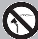
Nunca retire tuberías pinzadas mediante soldadura.
