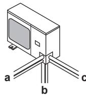
**3** Seleccione una ruta para la tubería (a, b o c).
