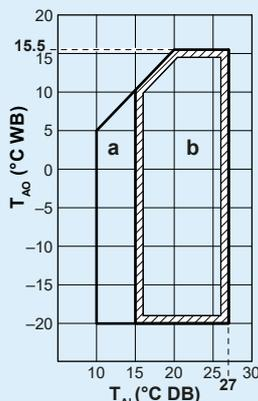
**a:** Límites de funcionamiento para calentamiento; **b:** Límites de funcionamiento en calefacción;  $T_{Ai}$ : Temperatura ambiente interior;  $T_{AO}$ : Temperatura ambiente exterior
