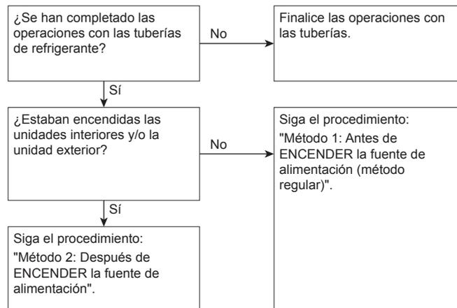
Es de vital importancia que las operaciones con las tuberías de refrigerante se realicen antes de encender las unidades (exterior o interior). Al encender las unidades, se activarán las válvulas de expansión. Esto significa que las válvulas se cerrarán.
