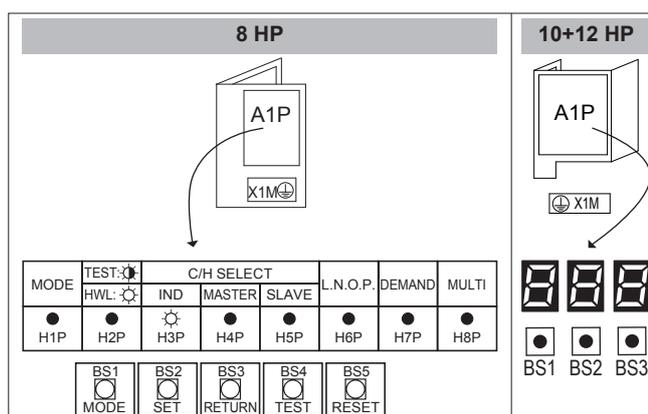
ENCENDIDO (☼) APAGADO (●) Parpadeando (☼)
