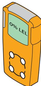
Un detector LEL mide si hay presencia de combustible (por ejemplo, R290) y qué cantidad hay en el aire (% vol.). Si la mezcla está entre LEL y UEL y se genera una chispa, puede producirse una explosión.
