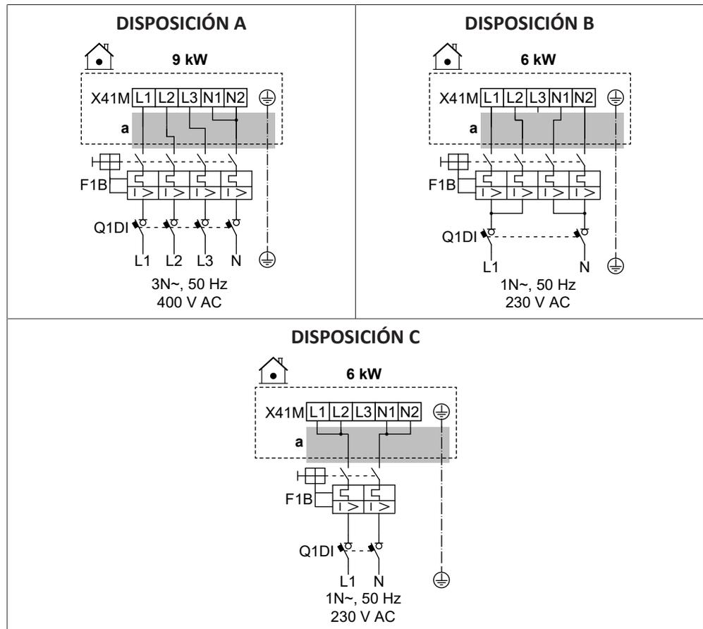
**Posibles disposiciones en el caso de los modelos de 4V (resistencia de reserva de varios pasos de 4,5 kW)**
