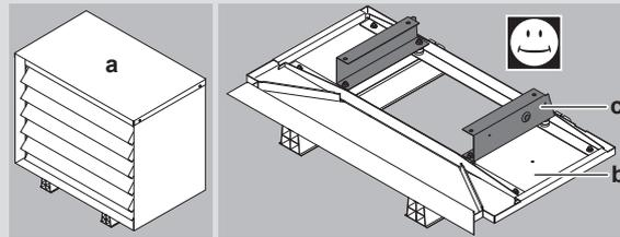
**a** Cubierta reductora de ruido
