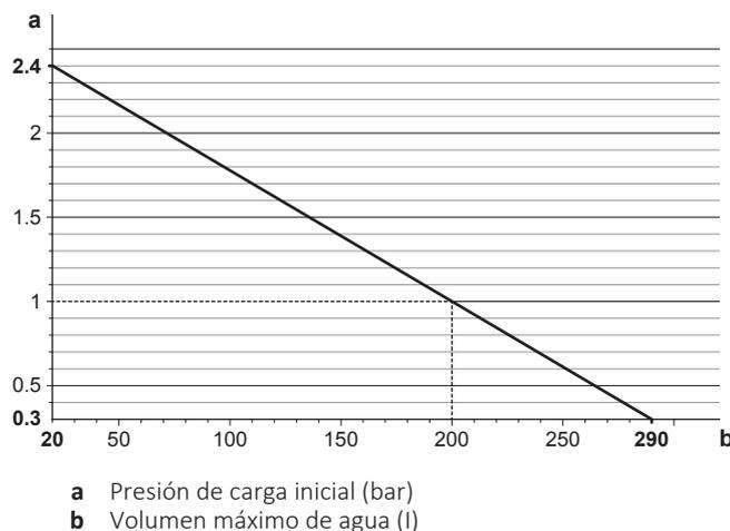
**Ejemplo: volumen máximo de agua y presión de carga inicial del depósito de expansión**
