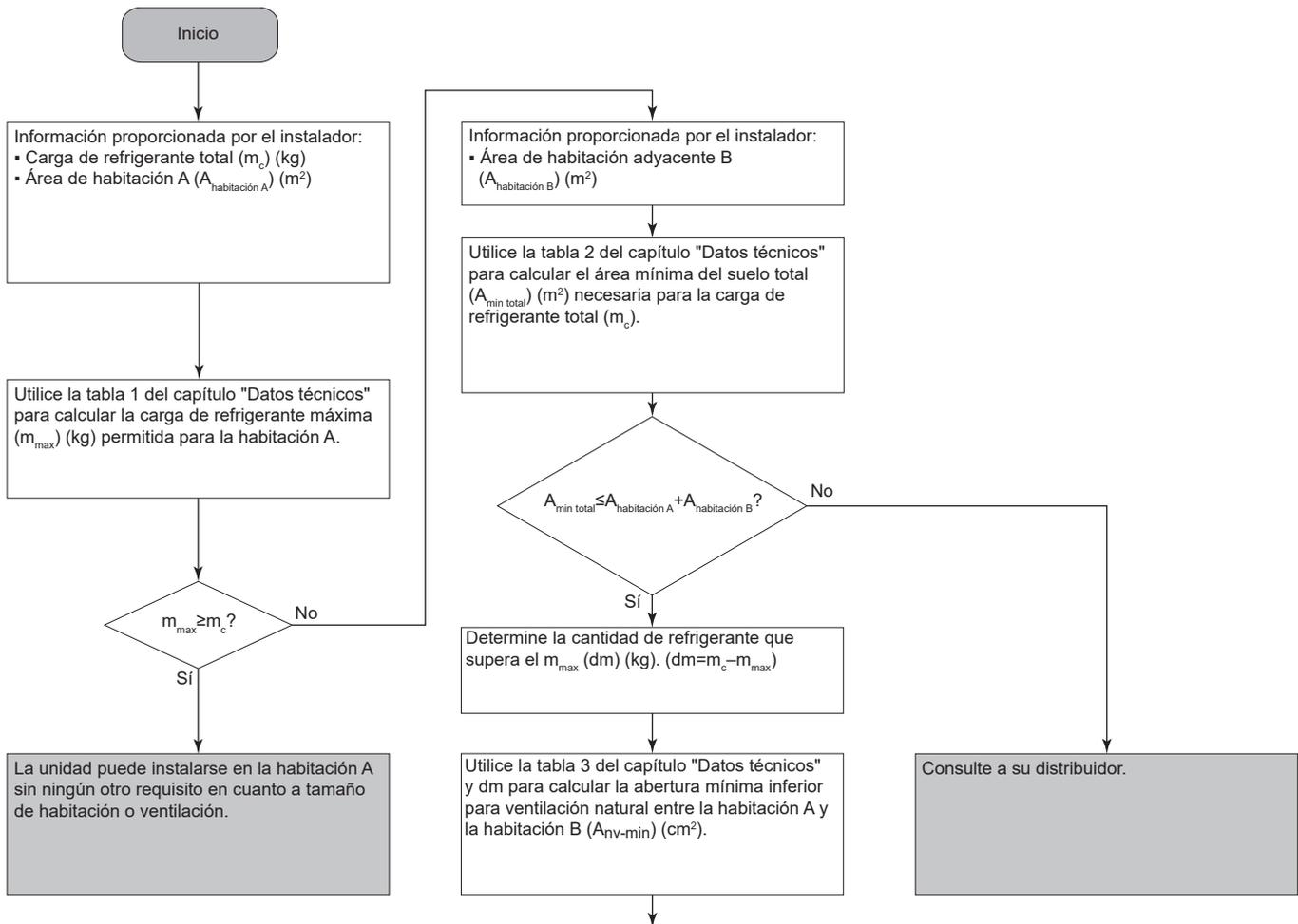
La unidad puede instalarse en la **habitación A** si dispone de 2 aberturas (una en la parte inferior y una en la parte superior) entre la habitación A y la B para garantizar la ventilación natural. Las aberturas deben cumplir con las siguientes condiciones:
