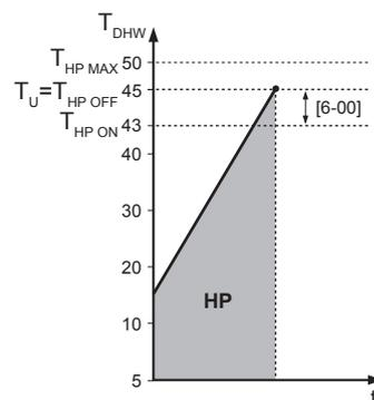
**HP** Bomba de calor. Si el tiempo de calentamiento por bomba de calor es excesivo puede activarse la resistencia de reserva para proporcionar un calentamiento adicional
