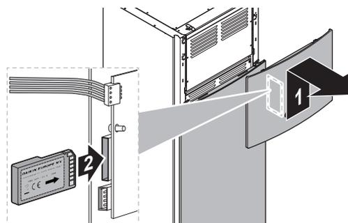
9.4 Para instalar la placa de montaje
