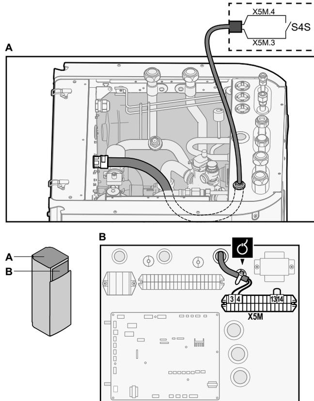
3 Conecte el cableado de alta tensión de la forma siguiente:
