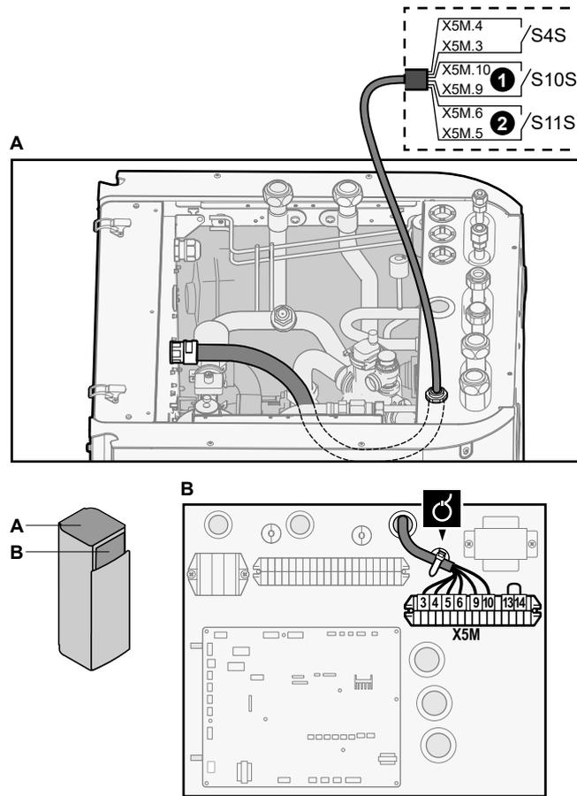
3 Fije los cables con abrazaderas a los sujetacables.
