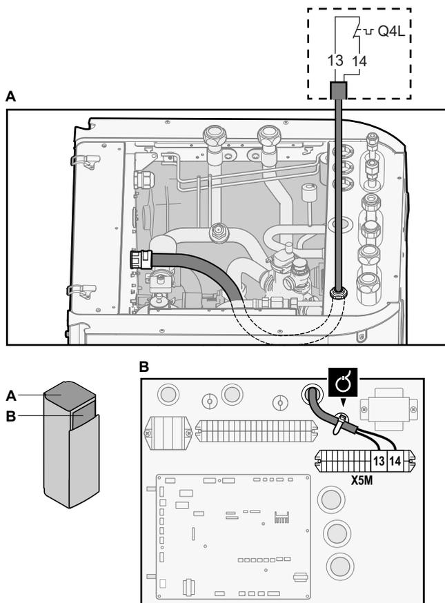
5 Fije el cable con abrazaderas a los sujetacables.
