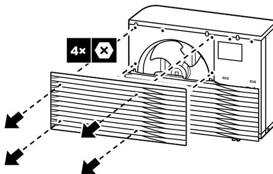
2 Retire la parte inferior de la rejilla de descarga.
