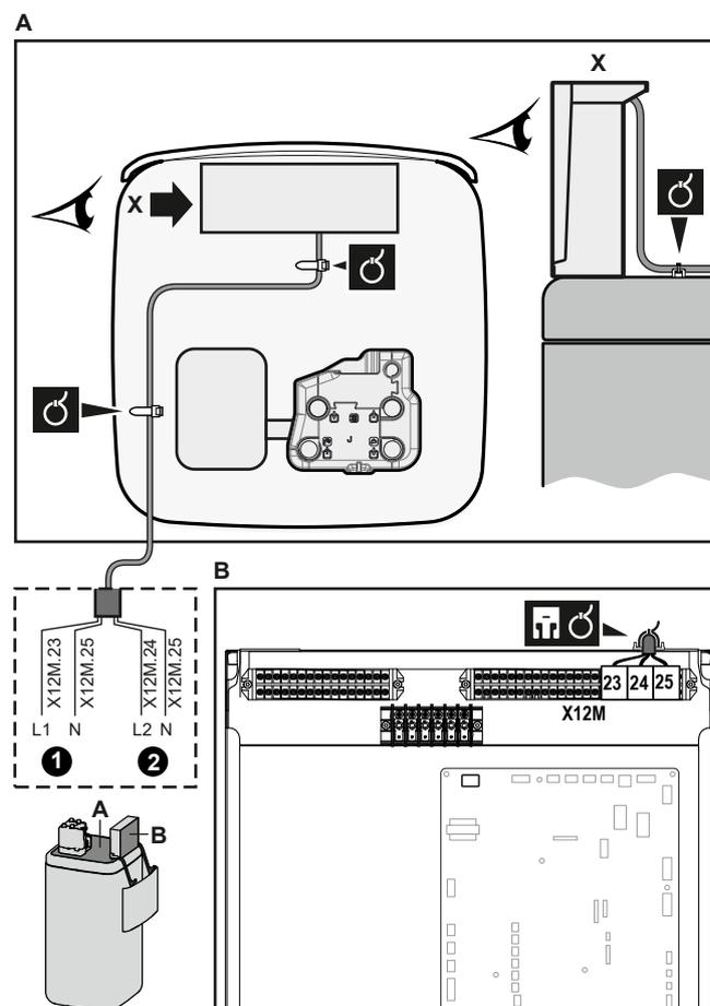
6 Fije el cable con abrazaderas a los sujetacables. Información general, véase "9.3.1 Conexión del cableado eléctrico a la unidad interior" [▶ 145].
