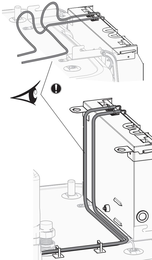
Todos los cables conectados a la caja de interruptores del ECH<sub>2</sub>O deben incorporar un mecanismo de alivio de tensión.
