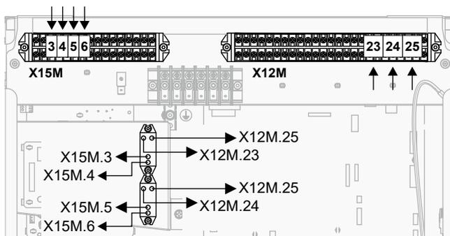
4 Conecte el cableado de baja tensión de la forma siguiente:
