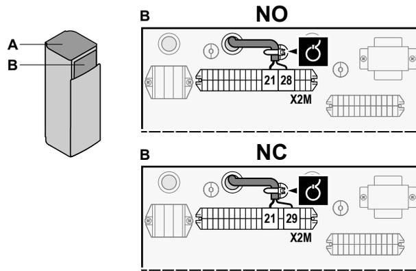
4 Fije el cable con abrazaderas a los sujetacables.
