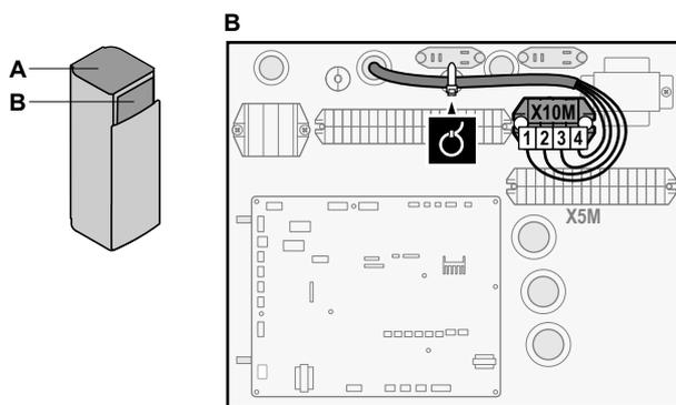
4 Fije los cables con abrazaderas a los sujetacables. Si es necesario, recoja la longitud sobrante de cable con una abrazadera.
