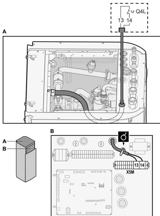
**4** Fije el cable con abrazaderas a los sujetacables.
