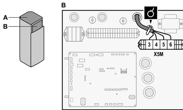
4 Fije el cable con abrazaderas a los sujetacables.
