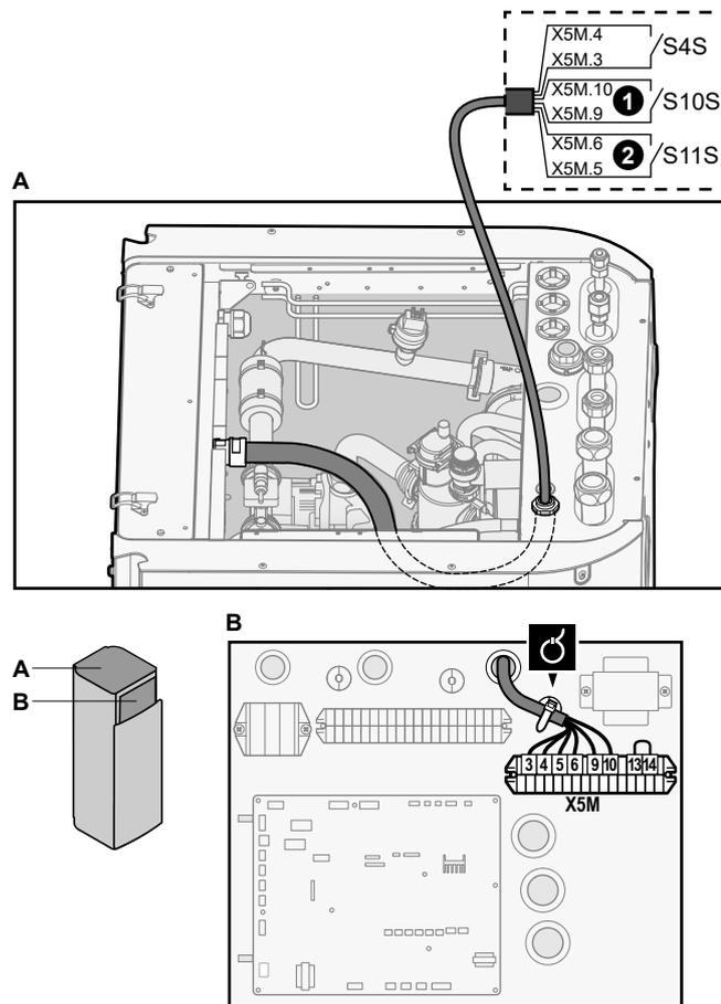
3 Fije los cables con abrazaderas a los sujetacables.
