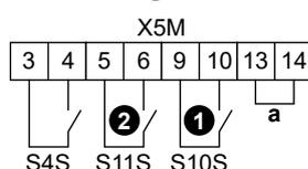
a Puente (montaje en fábrica). Si también conecta un termostato de seguridad (Q4L) sustituya el puente por los cables del termostato de seguridad.
