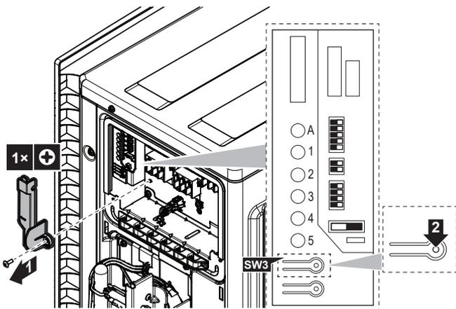
2 Pulse brevemente el interruptor de comprobación de errores de cableado (SW3) en la PCB de servicio de la unidad exterior.
