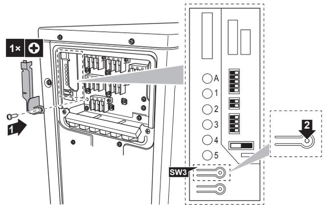
2 Pulse brevemente el interruptor de comprobación de errores de cableado (SW3) en la PCB de servicio de la unidad exterior.
