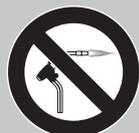
Nunca retire tuberías pinzadas mediante soldadura.
