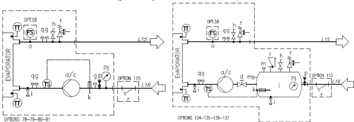
**Fig. 18 – Diagrama hidráulico para bomba única / dos bombas (opc. 78-79-80-81/134-135-136-137) (presión operativa máxima 6 bares)**
