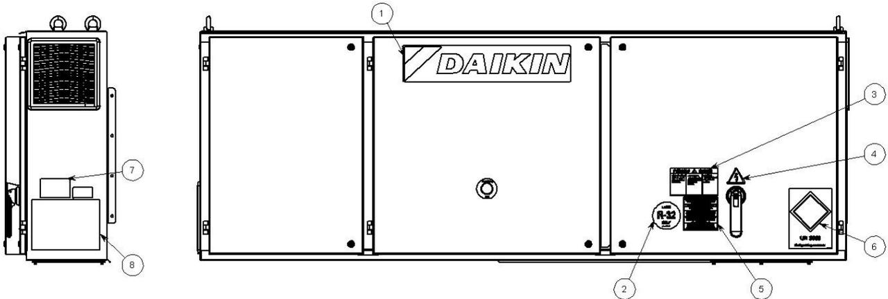
Fig. 23 – Descripción de las etiquetas fijadas al panel eléctrico EWYTx0B
