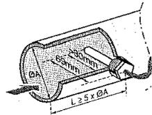
Elija la ubicación de esta conexión de forma que la longitud del cable del sensor (10 m) sea lo suficientemente larga.
