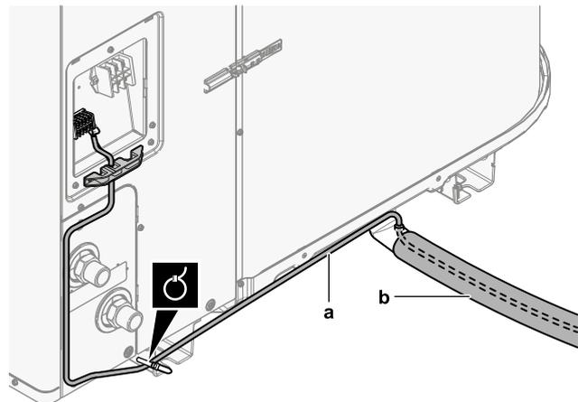
a Cable de la resistencia del tubo de drenaje
