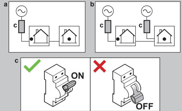
Para advertir al usuario, coloque los adhesivos "NO APAGUE el disyuntor" en el armario eléctrico y lo más cerca posible de los disyuntores de la bomba de calor. En la pegatina, rellene el número de referencia del disyuntor para garantizar la máxima claridad.
