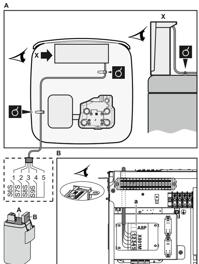
4 Fije el cable con abrazaderas a los sujetacables. Información general, véase "6.3.1 Conexión del cableado eléctrico a la unidad interior" [p 24].
