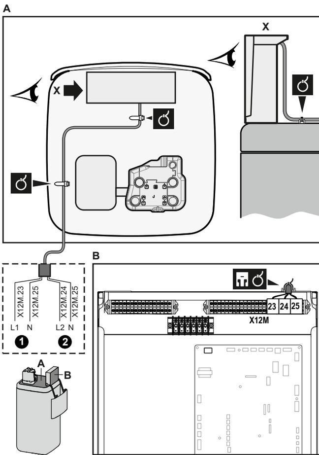
6 Fije el cable con abrazaderas a los sujetacables. Información general, véase "6.3.1 Conexión del cableado eléctrico a la unidad interior" [p 24].
