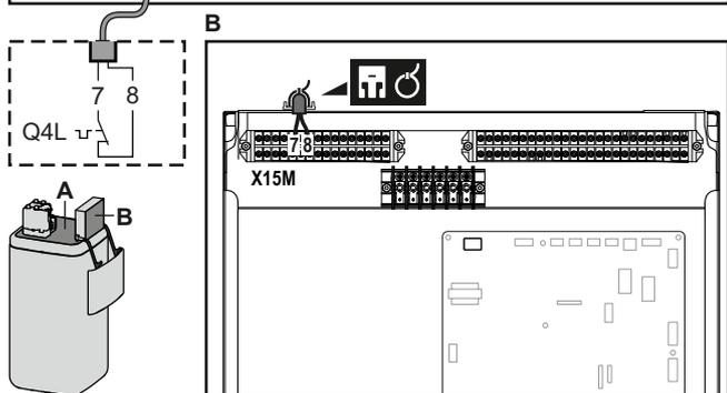
3 Fije el cable con abrazaderas a los sujetacables. Información general, véase "6.3.1 Conexión del cableado eléctrico a la unidad interior" ▶ 24].
