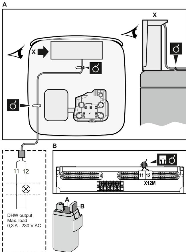
3 Fije el cable con abrazaderas a los sujetacables. Información general, véase "6.3.1 Conexión del cableado eléctrico a la unidad interior" ▶ 24].
