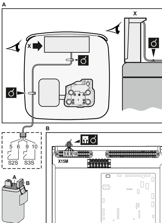
3 Fije el cable con abrazaderas a los sujetacables. Información general, véase "6.3.1 Conexión del cableado eléctrico a la unidad interior" [p 24].
