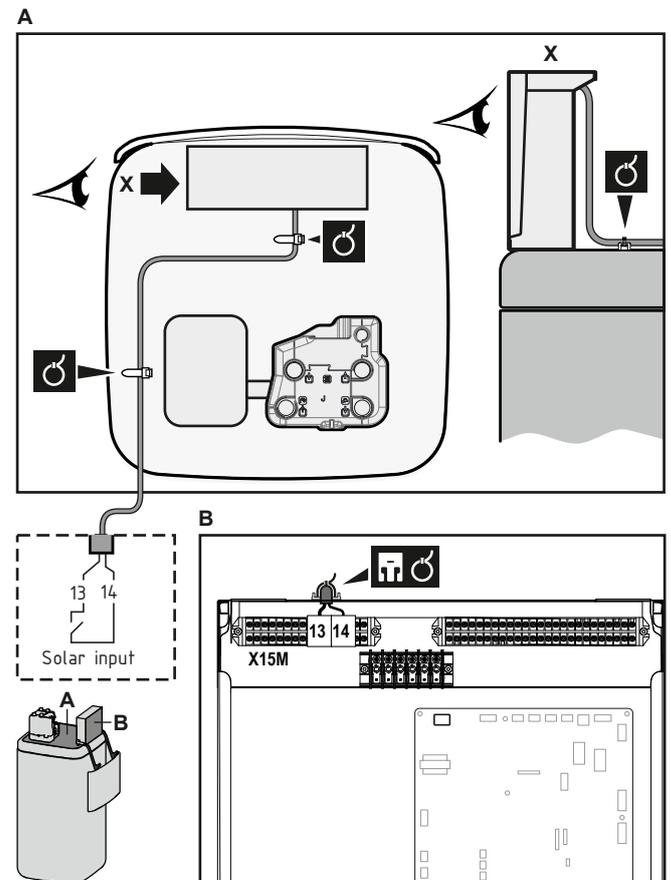
3 Fije el cable con abrazaderas a los sujetacables. Información general, véase "6.3.1 Conexión del cableado eléctrico a la unidad interior" [p 24].
