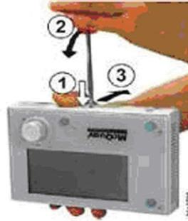
Extracción de la cubierta
