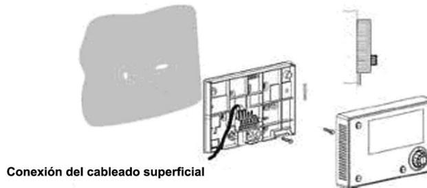
Conexión del cableado superficial
