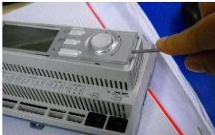
Tenga cuidado de no dañar la cubierta de plástico. Coloque la nueva batería en el sujetador de batería, que aparece resaltado en la siguiente imagen, respetando las polaridades indicadas en el sujetador mismo.
