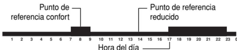
Punto de referencia confort      por defecto 21,0°C en modo calefacción (24,0°C en modo refrigeración)
