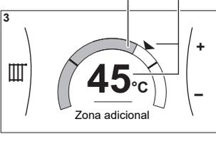
a Temperatura del agua de impulsión real
